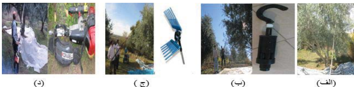
شکل ۲: روش‌های برداشت الف: چوب‌زنی، ب: شاخه‌تکان فرقونی، ج: شانه مکانیکی د: شاخه‌تکان دستی
